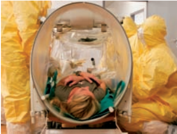
Abb. 2: Einschleusen eines Patienten in einen Transportisolator (Übung). Die Besatzung ist in dieser Phase durch PSA geschützt. Für den Transport wird die Stirnseite verschlossen, der Isolator anschließend dekontaminiert. (Foto: C. Bartels)
