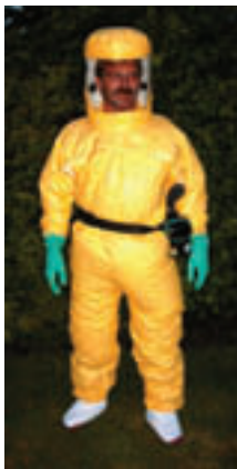
Abb. F: Schutzanzug mit integrierter Kopfhülle und Gesichtsspritzschutz, Füßlingen und Handschuhen. Der gebläseunterstützte Atemschutz wurde mit Kombinationsfilter ABEK2-P3 ausgestattet. Das Material des Schutzanzuges ist flüssigkeitsdicht und erlaubt eine Ganzkörperdekontamination (Duschen).
