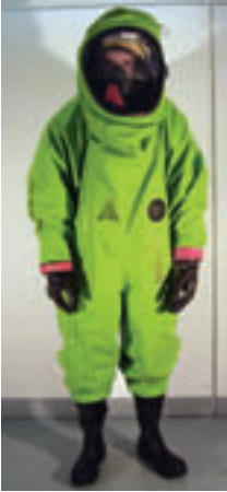
Abb. G Chemikalienschutzanzug mit umluftunabhängigem Atemschutz. Das Material des Schutzanzugs ist flüssigkeitsdicht/ gasdicht, hält erhöhter mechanischer Belastung stand und erlaubt daher eine Dekontamination und ein erweitertes Arbeitsspektrum, dadurch wird jedoch die Beanspruchung beim Tragen stark erhöht.
